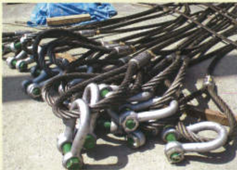
玉掛ワイヤー シャックル チェンブロック 平衡滑車 他
